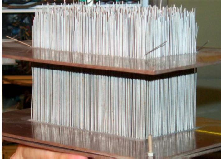
FIGURE 3.2 – *Milieu prototype pour l'étude de la diffusion multiple. L'échantillon présenté sur cette photo est constitué de 2400 tiges en acier inox réparties aléatoirement à raison d'environ 19 tiges/cm<sup>2</sup>. Le diamètre de chaque tige vaut 0.8mm.*
